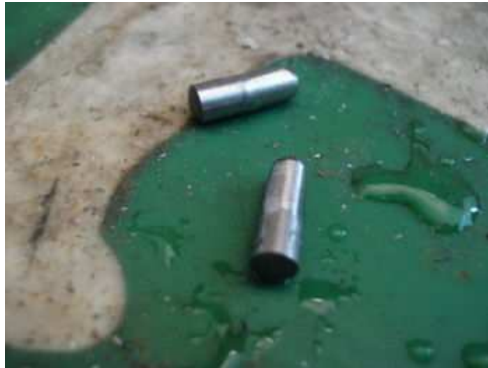
Reduction légère des butées en 100C6 pour faciliter l'insertion a la masse.
