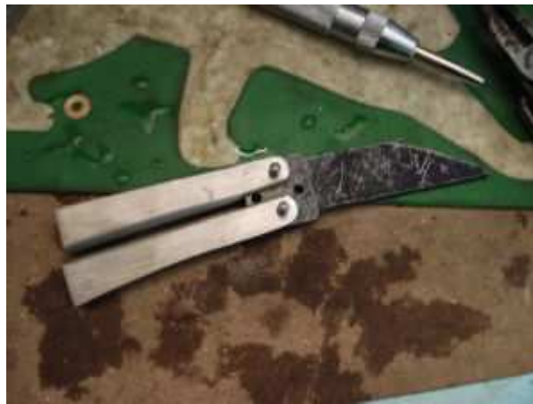
Un peu de mise en forme à la bande grain 60
