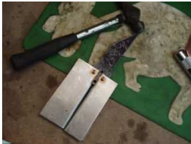
Pré assemblage avec les rondelles pour voir ou il ne faut pas bouffer autour du pivot.
