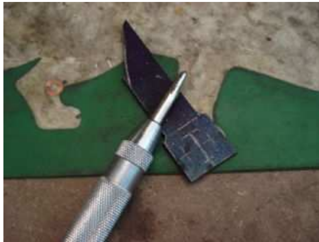
Marquage des points de perçages et Pointage au pointeau (rien d'original)
