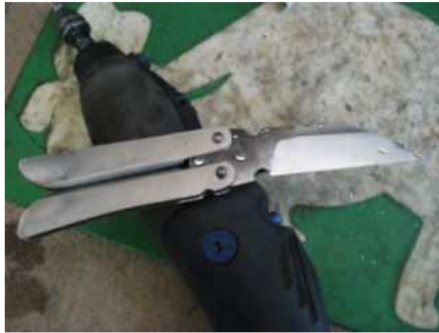
Ajustage des tang cup à la dremel. fermé
