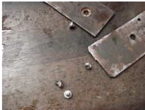
Reduction de la taille des vis et polissage de la découpe
