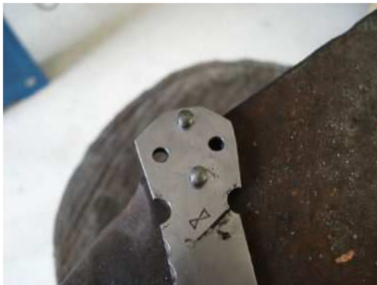
Butée en place mise à la taille et polie ( tout comme la gravure.)
