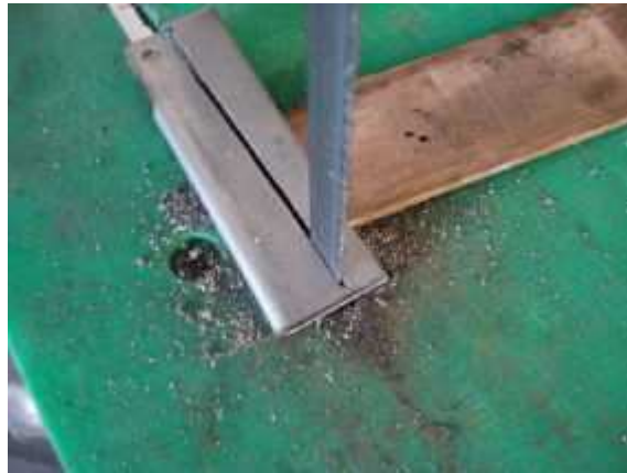
Découpe à la scie à ruban. (pour couper ce genre de tôle, cela vibre méchamment, pensez à mettre une cale d'épaisseur sur la partie que vous coupez. Cela permet à la fois de tenir et guider la pièce mais de limiter les vibrations.)
