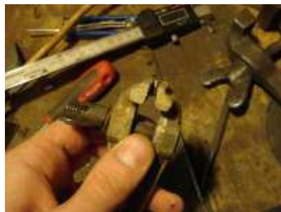
Nettoyage de la partie limée au 150 enroulé autour de la lime
