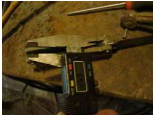
Un pivot de 8mm de long dans mon petit étaux à main pour une mise à dimension à la lime.
