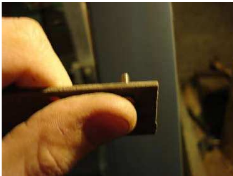
Finalement, j'ai décidé de noyer le pivot dans la seconde branche également, donc perçage à 4,8 mm puis alésage à 4,99.
