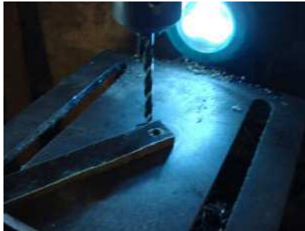
Alésage avec alésoir carbure 4,99mm.
