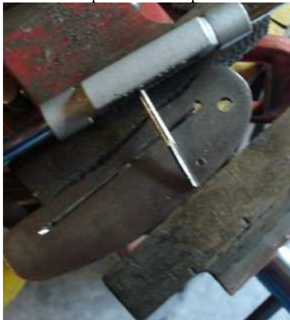
Perçage pour la butée et taraudage.
