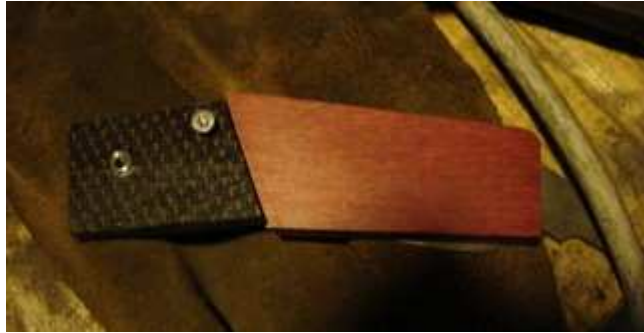
FC percée, j'ajuste le micarta.
