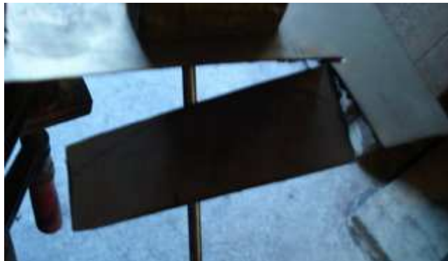
C'est coupé. Le titane grade 2 en 0.8 mm d'épaisseur c'est moins dur à couper que le grade 5 en 3mm :D
