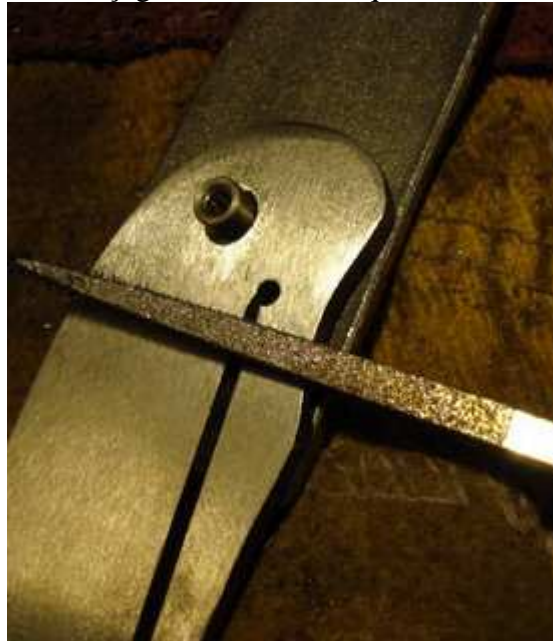
On test histoire de voir si on a pas été trop mauvais. Et on marque le point de contact futur entre le talon de la lame et la patte de verrouillage.
