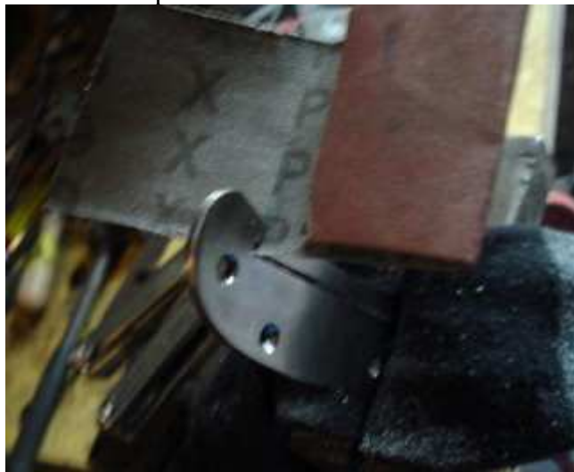
Nettoyage de la partie en contact avec un morceau de bande.
