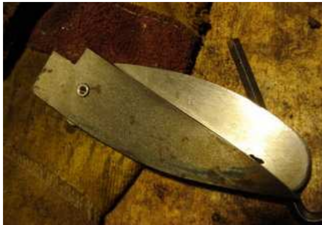
J'attaque l'acier à la bande grain 40.
