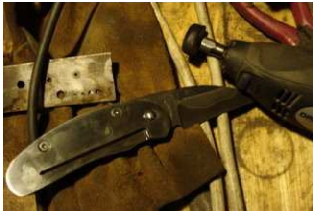
Je nettoie et polie la platine en titane.
