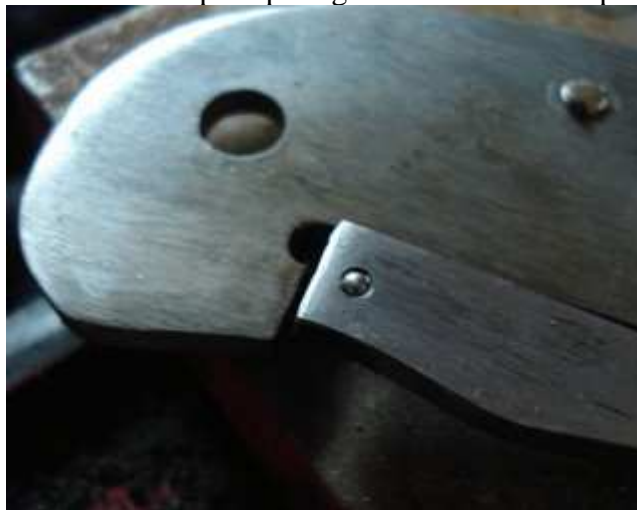
La bille est à la fois collée à la résine époxy et mise en force. Il faut prendre soin à ce qu'elle ne dépasse pas trop sinon il sera extrêmement difficile d'ouvrir la lame.
