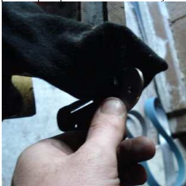
Une chaussette pour protéger dans l'étai et on plie.
