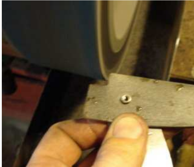
J'attaque l'acier à la bande grain 40.
