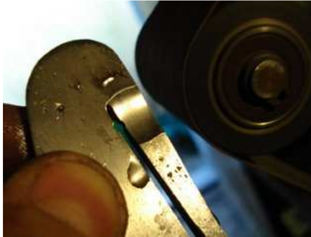
Roue de 40 pour marquer le point de flexion et faciliter justement le pliage.
