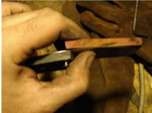
Ajuste la partie du micarta en contact avec la fc.
