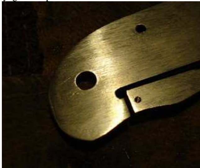
Marquage et perçage de l'emplacement pour la bille de contact.
