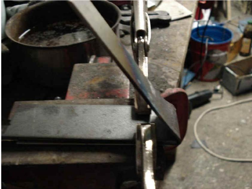
Voilà ce que l'on obtient au premier pliage. La lame est sur son pivot et l'on voit que la pointe passe parfaitement
