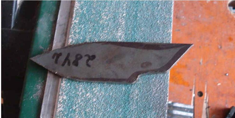
Une fois la forme bien réalisée, vous pouvez percer le trou du pivot à l'aide du forêt de 5 mm de diamètre. Avant de percer marquez le point à percer avec le pointeau et le marteau afin que le perçage se fasse exactement à l'endroit souhaité. Le perçage se fera sur le tiers inférieur de la lame.
