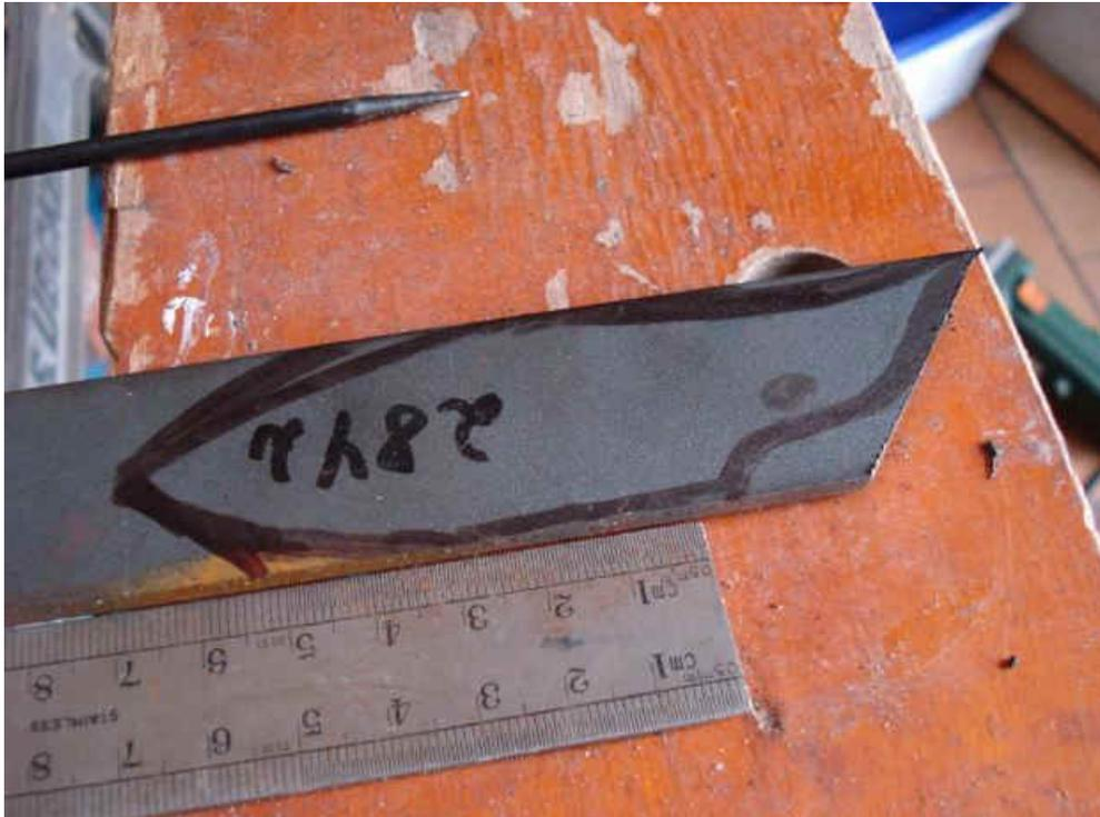
Couper l'acier à la forme souhaitée. Pour cela disqueuse et disque à tronçonner l'acier. Prenez un peu de marge afin de faire une mise en forme au disque à ébarber.
