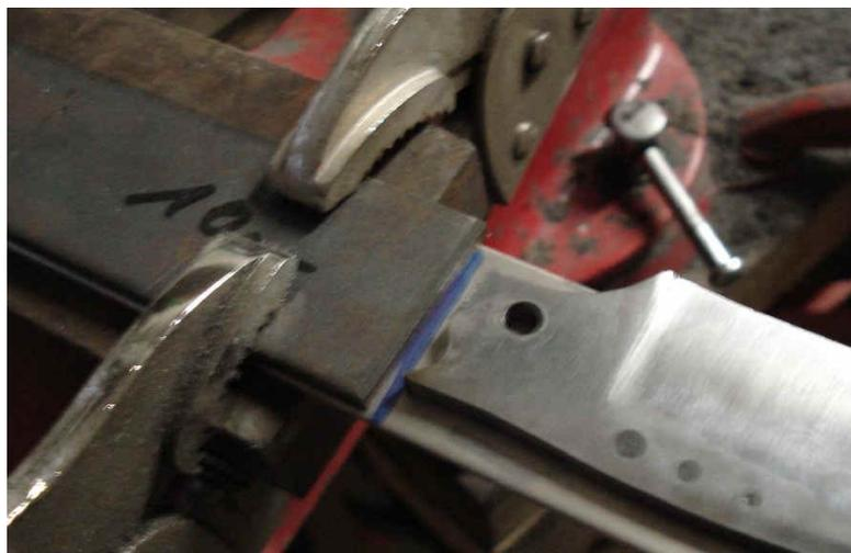
Chauffez à l'aide du chalumeau au niveau du point de flexion et à l'aide du marteau (en portant des gants), martelez du bas vers le haut au niveau que vous chauffez afin de plier la matière autour du plat d'acier qui est fixé sur le titane. Coupez le chalumeau, et refroidissez les pièces pour pouvoir les manipuler
