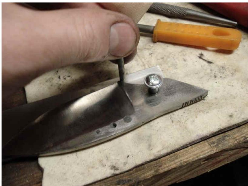
La butée est en place, la lame tourne sur le pivot, il ne reste plus qu'à retoucher le talon afin que la lame puisse se trouver dans l'axe du manche. Là j'avais laissé bcp de marge, j'ai recoupé à la disqueuse (cette partie n'est pas trempée donc pas de risque de détrempe).
