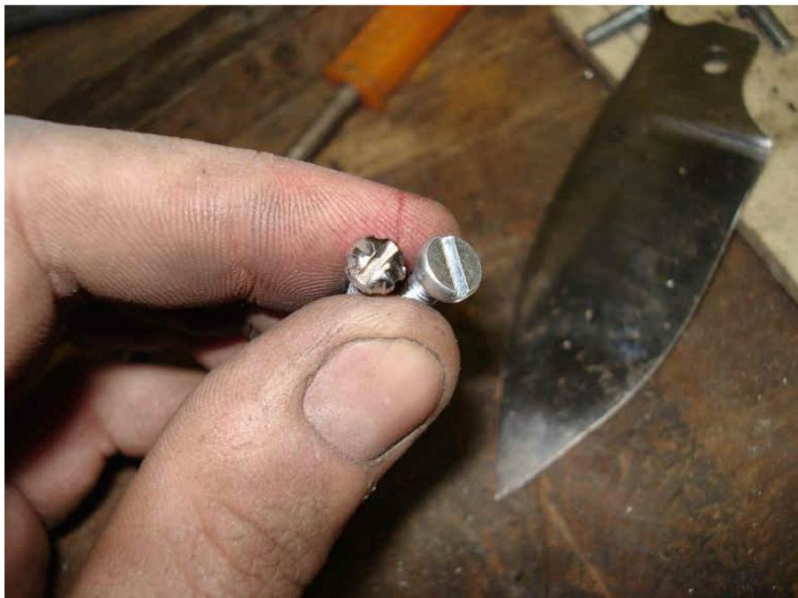
Coupez à l'aide du disque à tronçonner dremel les vis à 3-4 mm grand maximum en prenant soin à la lime d'avoir le bas de la vis de propre et de plat.
