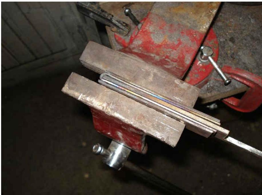
Il reste à percer les trous au travers des trous déjà présent
