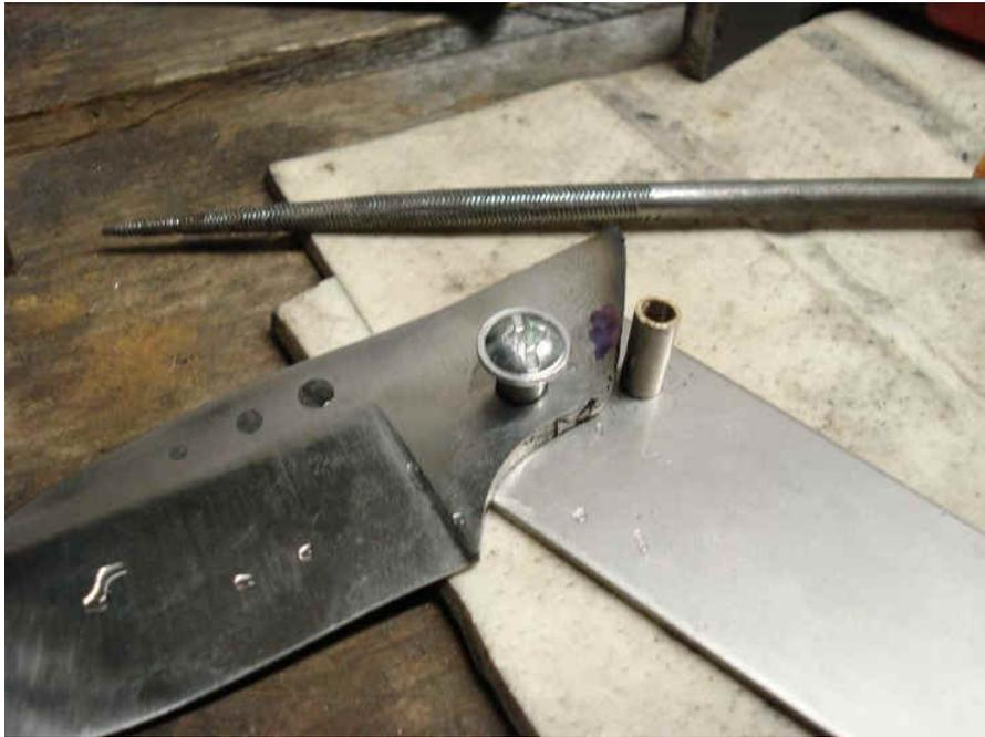
Une fois à la bonne taille à l'aide d'un petit tambour de ponçage sur la dremel retravaillez le talon pour que la lame s'ajuste parfaitement autour du clou de butée. (il est possible que simplement à la recoupe le talon vienne se positionner correctement, mais dans mon cas il fallait creuser un peu
