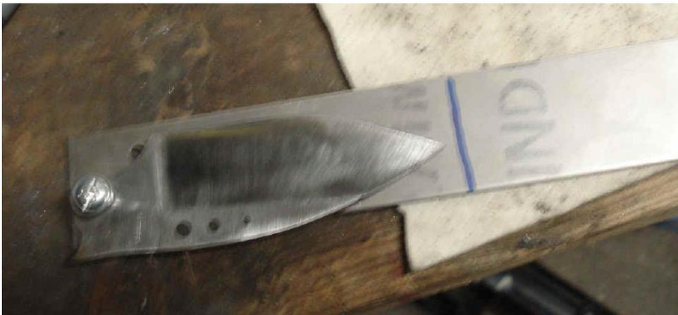
Fixez le plat sur une surface métallique (chaleur oblige) Sur ce plat sera fixé une plaque d'acier de l'épaisseur de celle que vous avez utilisé pour la lame (ici c'est un morceau d'O2 de 3,2mm comme la lame). Le bout de ce plat d'acier sera à peu près à 5mm de la ligne de flexion.
