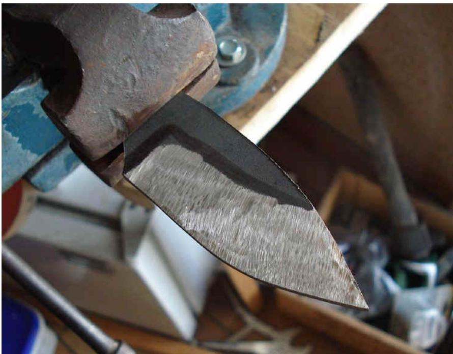
Ensuite continuez la réalisation de l'émouture à la ponceuse à bande, grain 40 puis 80 puis 120 (avant tt vous pouvez rester à 80 d'ailleurs). Refroidissez la lame régulièrement dans de l'eau et gardez à peu près 1 mm au niveau du tranchant de façon à ne pas décarburer le futur tranchant lors du traitement thermique.
