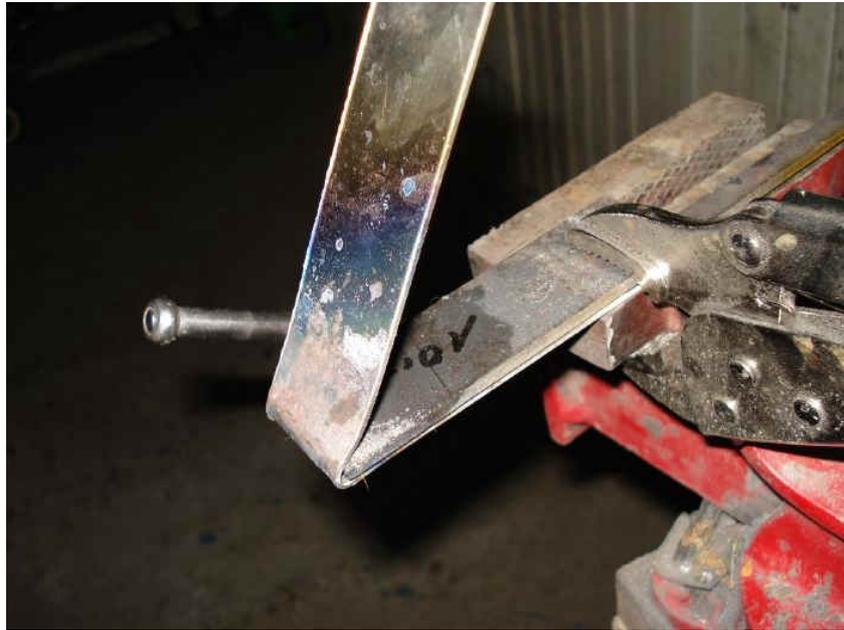
On démonte et refroidi la pièce (manipulez avec des pinces c'est très chaud). Ensuite positionnez l'ensemble dans un étau et pliage vers le bas (gravité oblige). Chauffez le point de flexion et à l'aide de l'étau serrez petit à petit jusqu'à ce que les plaques soient jointives. Arrêtez de chauffer et refroidissez les pièces dans l'eau. (toujours avec des pinces)
