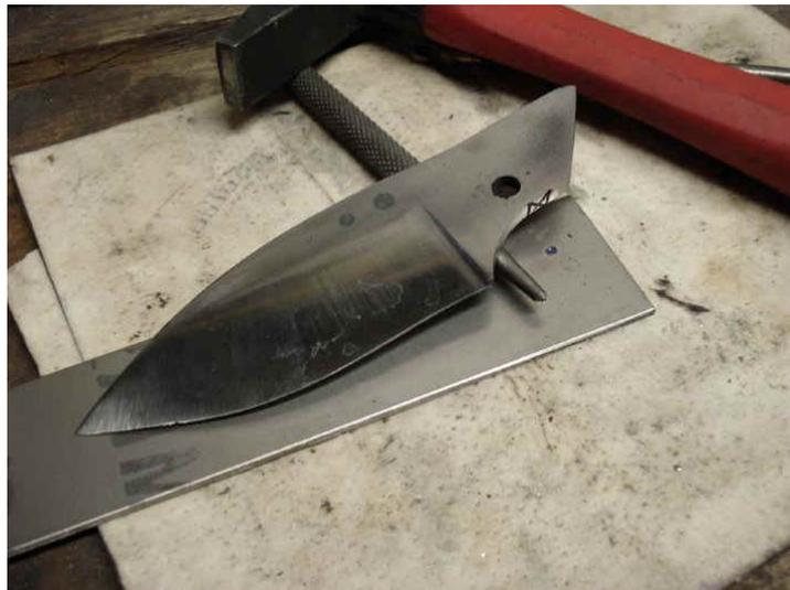
Une fois le trou percé, mettez le pivot dans la lame et mettez la lame sur le plat, fait pivoter la lame en position fermée et placez un clou ou la future butée au niveau du ricasso. Marquez le point et percez à l'aide du forêt de 4mm (la butée ne sera pas traversante quant à elle).
