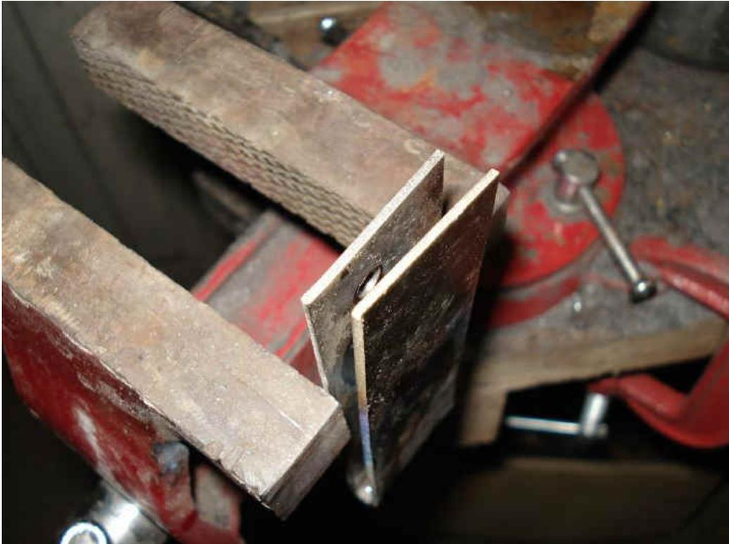
Pour tout bien ajuster, le manche avec l'acier qui simule la lame à l'intérieur, deux plaques de métal pour servir de protection au manche par rapport aux mordaches de l'étau. On chauffe le point de flexion et on sert au fut et à mesure. On laisse refroidir et notre plat est plié.
