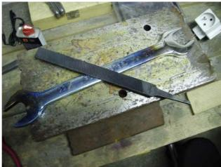
Détrempe de la lame au chalumeau. Chauffez la lame au rouge (jusqu'a ce quelle ne soit plus magnétique) et laisser refroidir doucement jusqu'à obtention de la température ambiante
