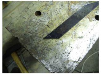
Percez l'arrière de la lame, c'est là que la tige de la lentille viendra prendre sa place. Ici un trou de 2mm pour une goupille élastique. Laissez 1 mm de marge par rapport au dos de la lame.
