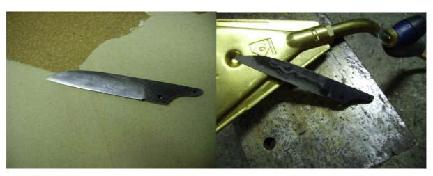
Trempe sélective au chalumeau. (Ici une gangue d'argile verte couplée à du charbon de bois et du sable)
