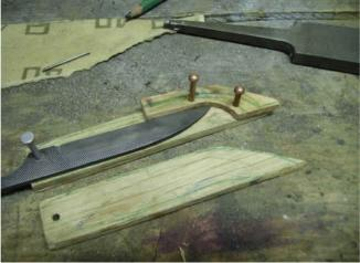
Percez le spacer de deux trous (ici 3mm pour des rivets cuivre) et percez la plaquette en vous servant des trous des spacers pour guide. (Percer le premier trou sur la plaquette, metteZ le spacer avec un rivet qui passe par ce même trou et percez le second trou au travers du spacer. De cette manière vous aurez simplement le même écartement. Faite la même chose sur l'autre plaquette.
