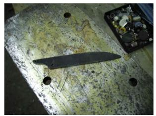
Mise en forme de la lentille et perçage du pivot. Le pivot se trouve dans le tiers inférieur de la lame.
