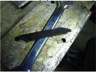
Découpe de la forme à la scie à métaux ou la disqueuse (disque le plus fin possible genre 1,65mm). A la disqueuse attention de ne pas trop chauffer l'acier.
