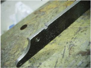
Réalisation de l'émouture de la lame. A la lime la plus abrasive que vous avez. Ensuite papier de verre sur cale à poncer du grain 40 au grain 120 par des passes allant du talon vers la pointe. La lame étant maintenue dans un étau. De cette manière vous obtiendrez une émouture parfaitement plate. Faite bien attention d'avoir une émouture symétrique par rapport au fil de la lame. Esthétiquement ce n'est que plus agréable.
