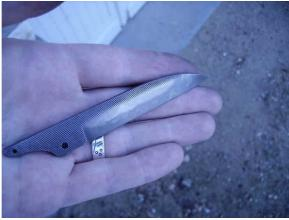
La lame après nettoyage, polissage et révélation de la ligne de trempe à l'acide.
