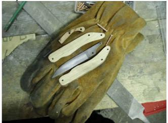
Un joli petit puzzle. Les pièces ont été retravaillées de façon à être relativement ergonomique. Et le spacer est parfaitement ajusté pour s'intégrer entre les plaquettes.
