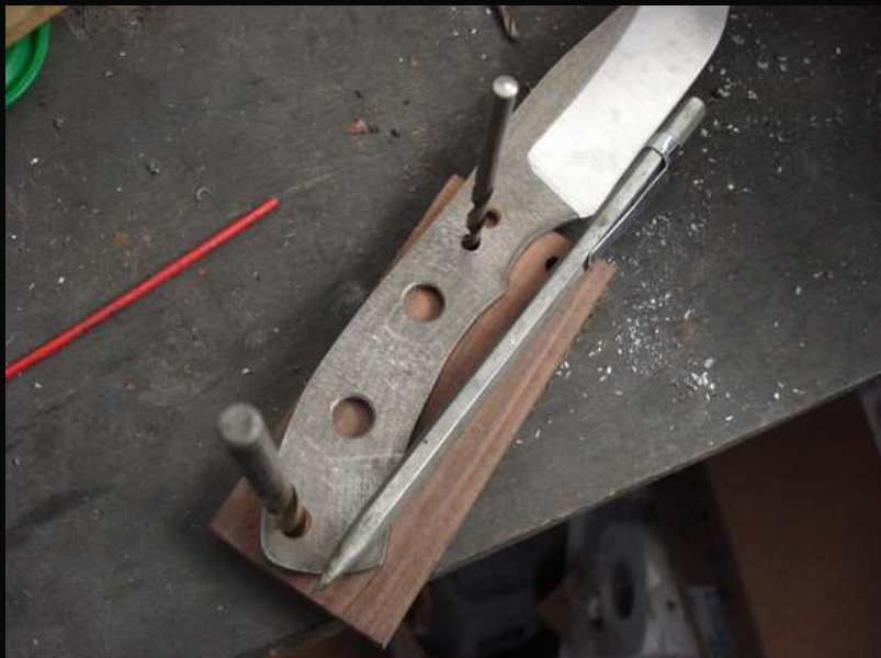
On trace la forme que l'on veut (vous remarquerez le que j'ai déplacé le perçage avant, l'emplacement me plaisait pas, trop près du bord de la plaquette à mon gout.
