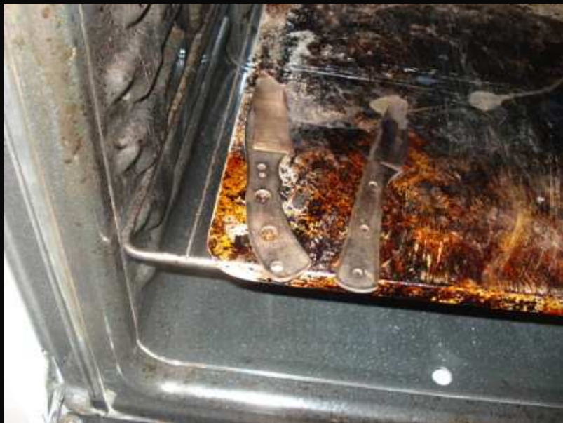
Placée au four pour le revenu à 200°C pendant deux fois une demi heure.
