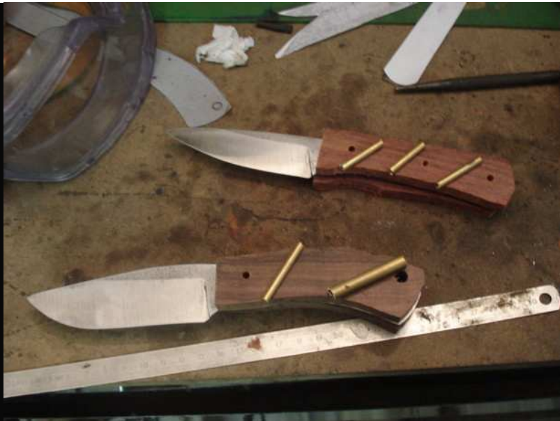
De la découpe de tiges de laiton et de tube.
