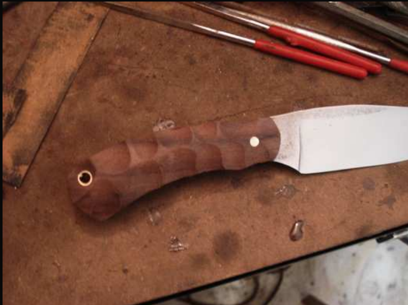
UN bon gros coup de roue de contact 60mm et bande 60
