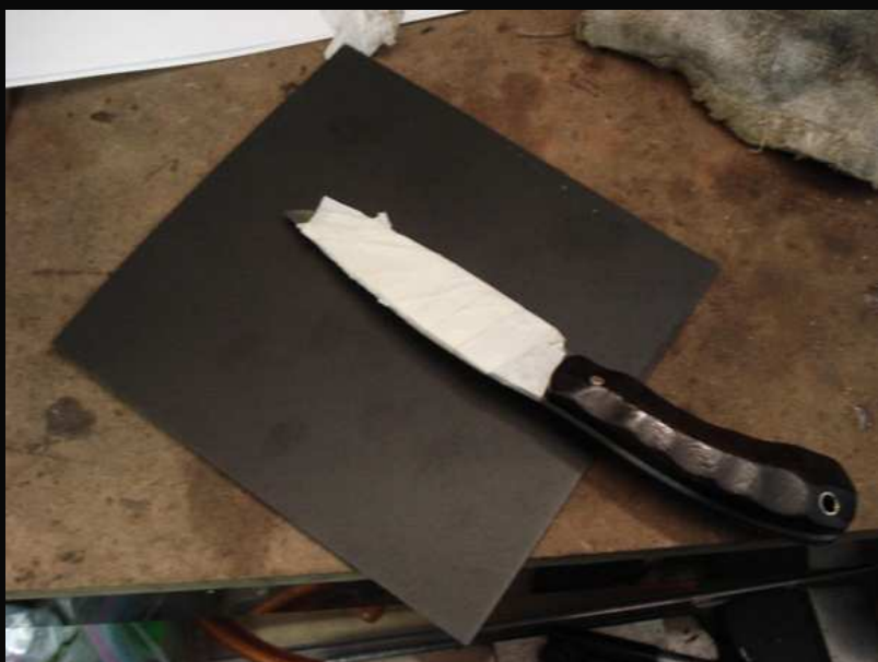
Un bout d'abs, de la bande de masquage pour éviter de trop serrer l'étui au moulage
