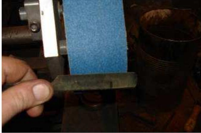
On attaque l'émouture à la bande 60 neuve, roue de contact de 150mm dureté 80 shore
