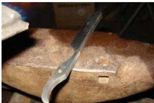
Le dos a été striée, 3 normalisations au chalumeau de plus en plus bas en ayant une chauffe bien homogène, chauffe de l'huile et trempe intégrale à l'huile
