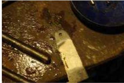
Un bout de T40 (ti grade 2) percé à 4mm et mis en forme à la bande
