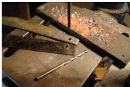
Perçage du pivot à 3,8mm, alésage à 4mm, et perçage du talon à 4mm
