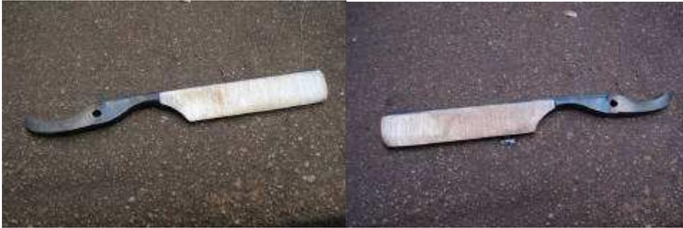
Après blanchissage de la lame et revenu au chalumeau. C'est pas visuel mais on est au doré "Naissant/installé".
