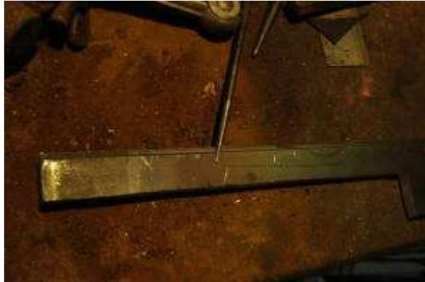
Sur une tôle de 100MnCrW4 de 5,9mm d'épaisseur, je dessine vaguement ma lame. Ici cela sera un 5/8 assez simple
