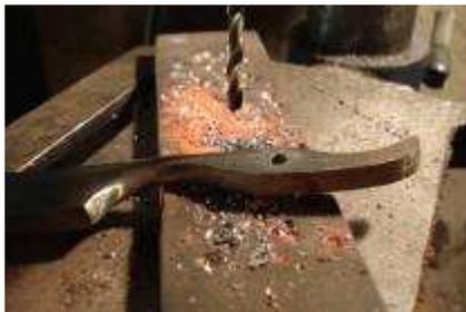
Perçage du pivot en 3,8mm.
