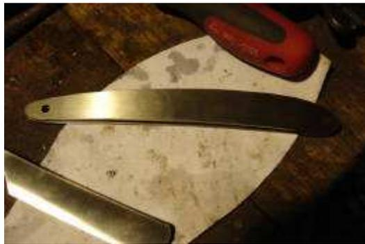
Les chasses sont mises en forme à la bande 60, le spacer est en place et riveté avec une tige de laiton, (collage époxy)
